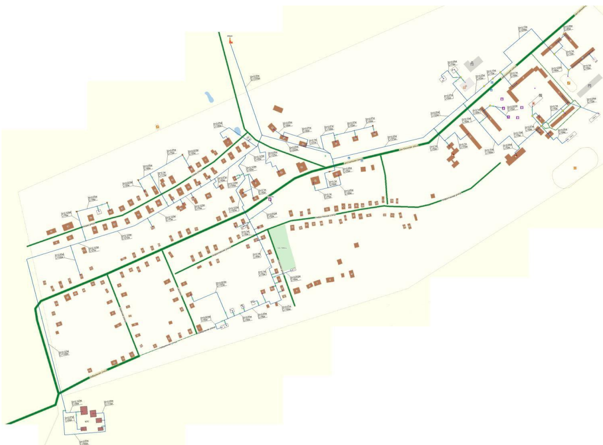
Рис.3.1 - Разработанная электронная модель системы теплоснабжения деревни Нифантово от блочно-модульной котельной БМК -14,2 ООО «Газпром теплоэнерго Вологда»
